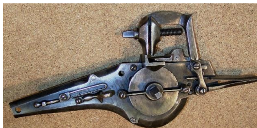
13-сүрөт. Леонардо да Винчинин дөңгөлөктүү кулпусу
